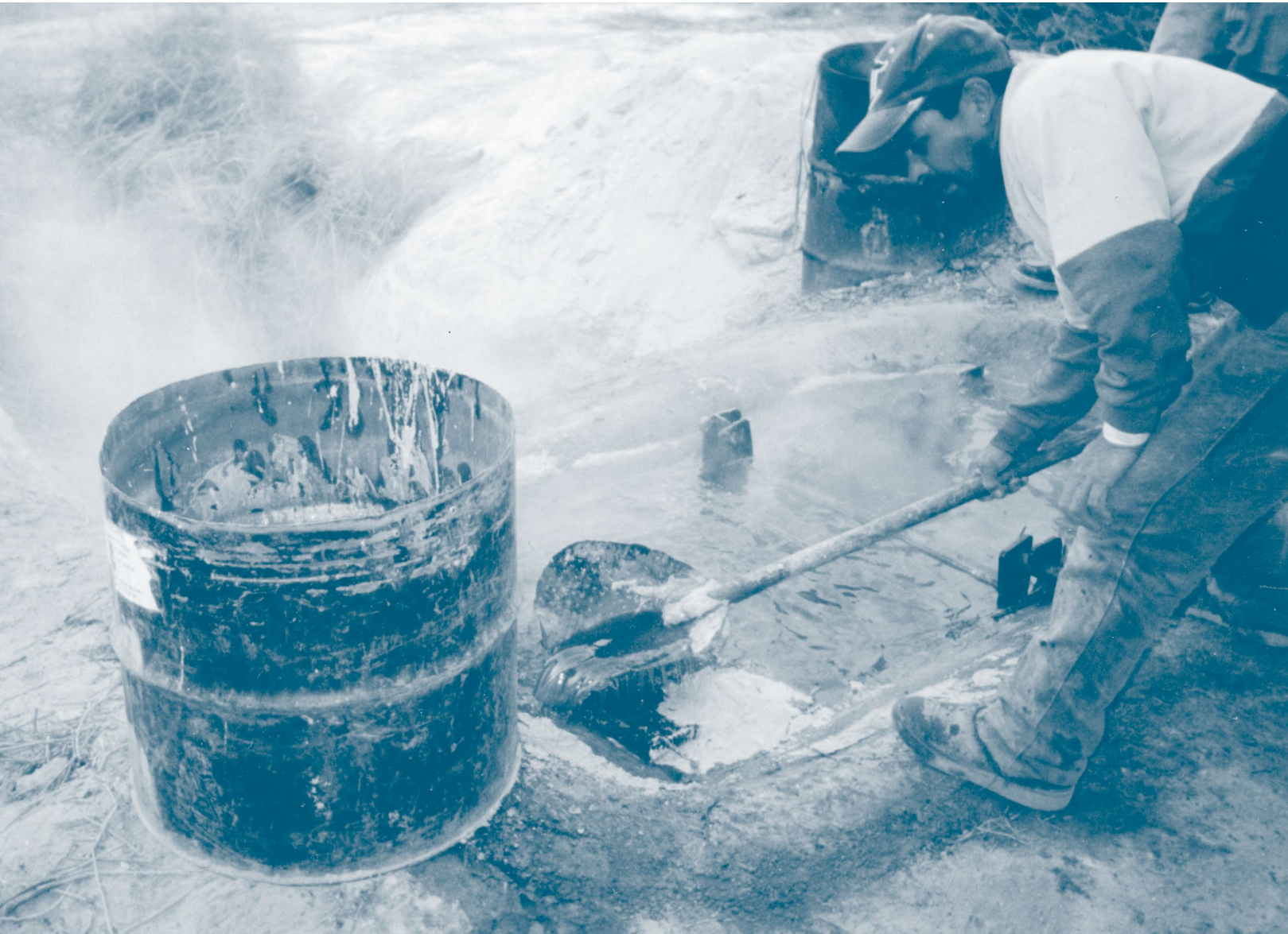
▲ Caldero de hierro conocido como paila , utilizado para la extracción de cera de candelilla ( Euphorbia antisiphilitica ). Municipio Cuatro Ciénegas, Coahuila. (Fotografía de Citlalli López)
